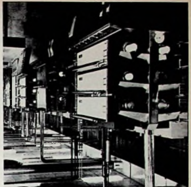
Afb. 16. Diffusie-ovens in een fabriek van halfgeleider-elementen (SGS).
