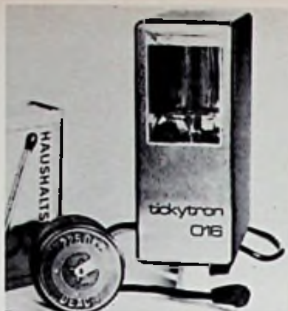
Afb. 23. Tickytron 016, tot nu toe de kleinste, met als vergelijkingsmaatstaf een lucifersdoosje. Ervoor de gasdichte Deac-batterij (foto Varta).
