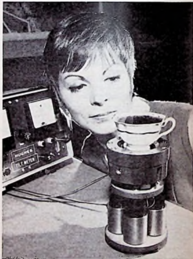
Een nieuwe sensor, uitgevonden door wetenschappelijke medewerkers van Hughes Aircraft, is zo gevoelig, dat het de aantrekkingskracht van de maan of zon op thee in een theekopje kan aantonen. Dat komt dan overeen met het meten van hellingshoeken met ongeveer één op de biljoen.
